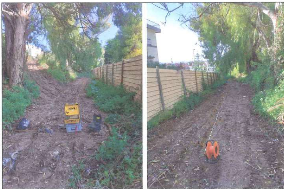
Foto 3 e 4: fase di esecuzione della prospezione sismica "M.A.S.W." denominata "M2" vista dagli estremi dello stendimento.
