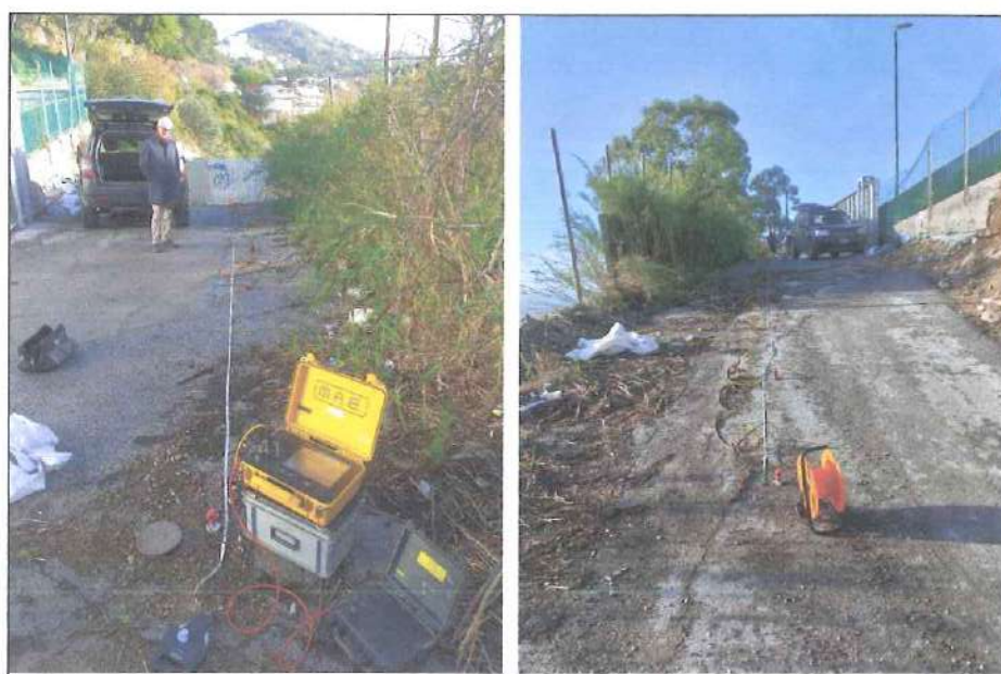
Foto 1 e 2: fase di esecuzione della prospezione sismica "M.A.S.W." denominata "M1" vista dagli estremi dello stendimento.
